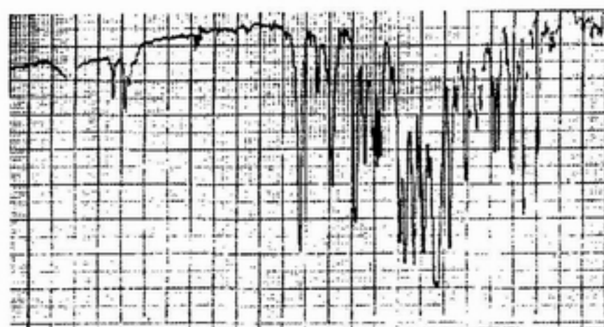
图 1 高效氯氟氰菊酯的标准红外光谱图
